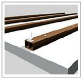
1. Verwenden Sie für die erste Terrassendiele die Anfangsclips. Diese werden auf der Unterkonstruktion befestigt, ein Vorbohren ist notwendig, siehe Skizze. Befestigen Sie nun die ersten Terrassendiele.
