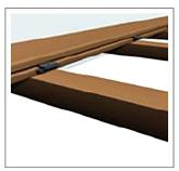
2. Installieren Sie nun Terrassendiele für Terrassendiele mittels WPC Befestigungsclips seitlich in den Nuten und den Clip auf der Unterkonstruktion mit einer Schraube. Auch hier das Vorbohren nicht vergessen. Wiederholen Sie diesen Vorgang bis Sie zur letzten Terrassendiele gelangen.
