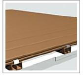
Als Abschlussprofil haben Sie die Möglichkeit eine Abschlusswinkel L-Form zu befestigen. Bei der Hausseiten muss dieser mit einem Abstand von mindestens 2 cm an der Hauswand und nicht an der Terrassendiele befestigt werden, damit das natürliche ausdehnen der Terrassendiele gewährleistet werden kann.
